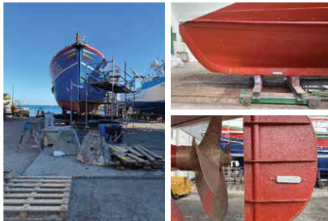
Figura 2 - exemplos de aplicação dos ânodos de sacrifício em barcos de pesca, nas quilhas e nos lemes. A sua colocação é em estaleiro após pintura, tendo uma durabilidade entre 1 a 4 anos conforme pretendido, devendo ser cuidadosamente seleccionados, adquiridos e substituídos ao longo da vida das embarcações.
